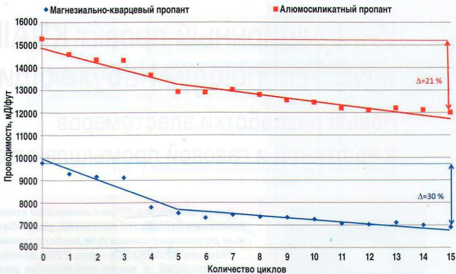
Рис. 2. Обработка результатов измерения остаточной проводимости пропантов в режиме циклического нагружения 6kpsi–3kpsi–6kpsi (15 циклов)
